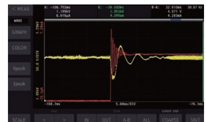
依據電壓變動率檢測異常事件
