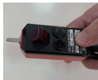
低壓迴路測試時按住銘板示意圖
