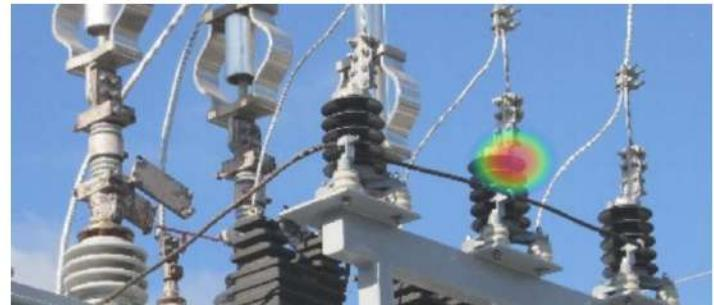
FLIR Si2-PD是一款簡單易用的聲學成像儀，可用於檢測電氣系統中的局部放電問題。這款輕巧的單手式聲學成像儀，可幫助專業工程人員發現問題，其速度比傳統方法快10倍。Si2-PD內建124顆麥克風，在遠距離或吵雜環境中也能直觀地顯示超音波訊息，產生精確的聲像。聲像即時疊加在可見光數位影像上，使用戶可以準確地找出異常聲音來源。在此基礎上，使用者可以運用軟體中或聲像儀中的局部放電類型分類和故障嚴重程度評估功能確定問題嚴重性，就解決問題提出建議和指導。
