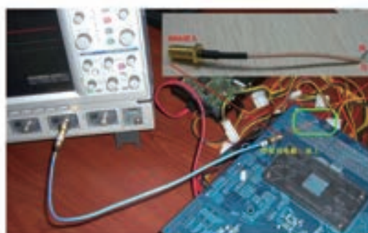
測量某電腦主板 DDR2 的 1.8V 的電源噪聲
